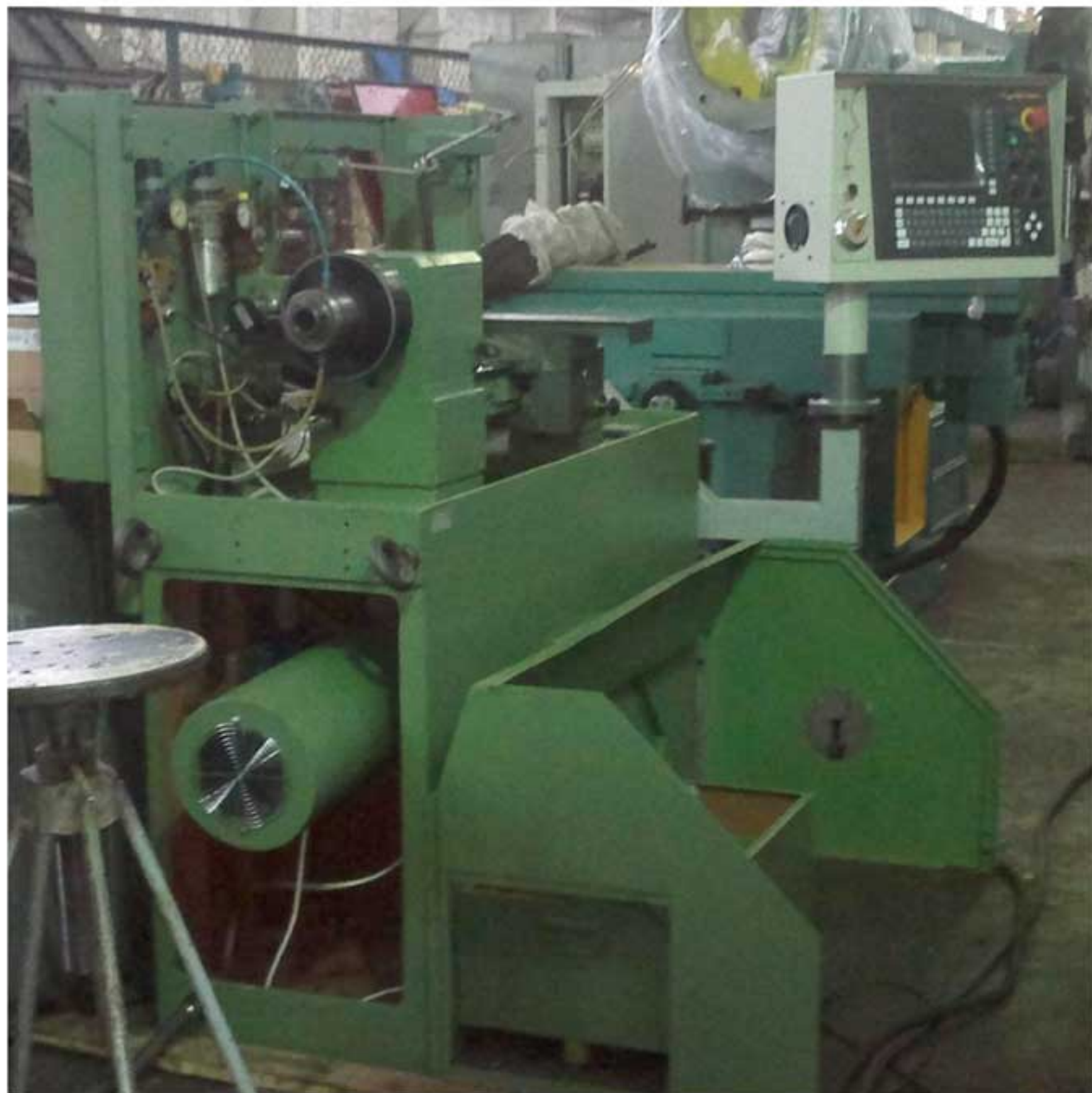
Общий вид универсального токарного станка Schaublin с ЧПУ и 2-мя осями
