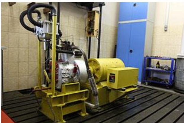
ГОСТ 20303 Масла моторные. Метод оценки моющих свойств на установке ИМ-1.
