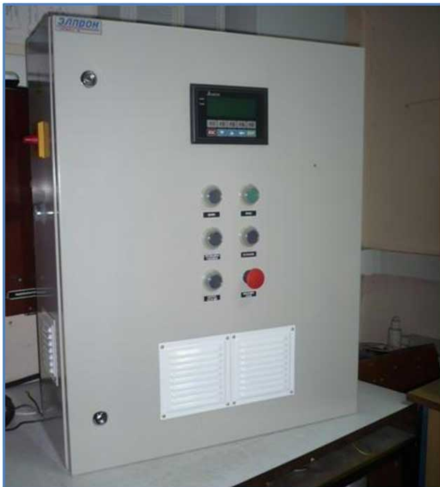
Лицевая панель шкафа управления с панелью оператора Delta TP04G-AL2)
