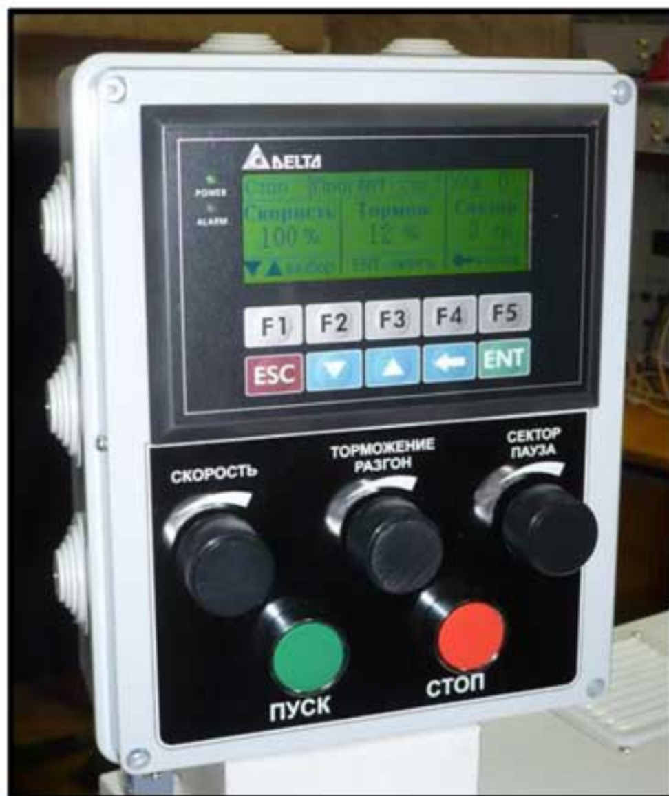
Лицевая панель шкафа управления (блок управления с панелью оператора Delta TP04G-AL2)
