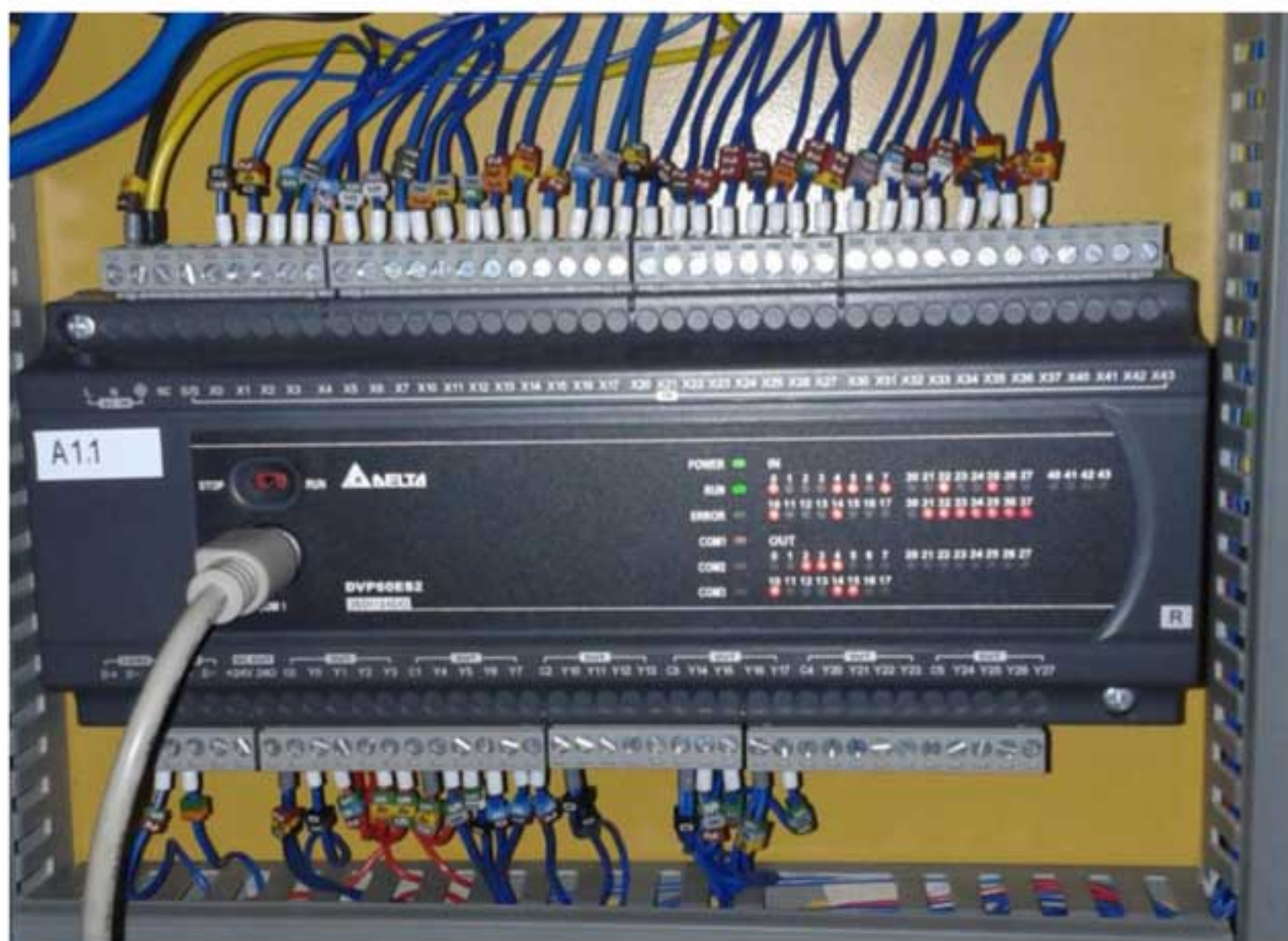
Схема управление станком построена на базе программируемого контроллера DVP 60ES200 .
