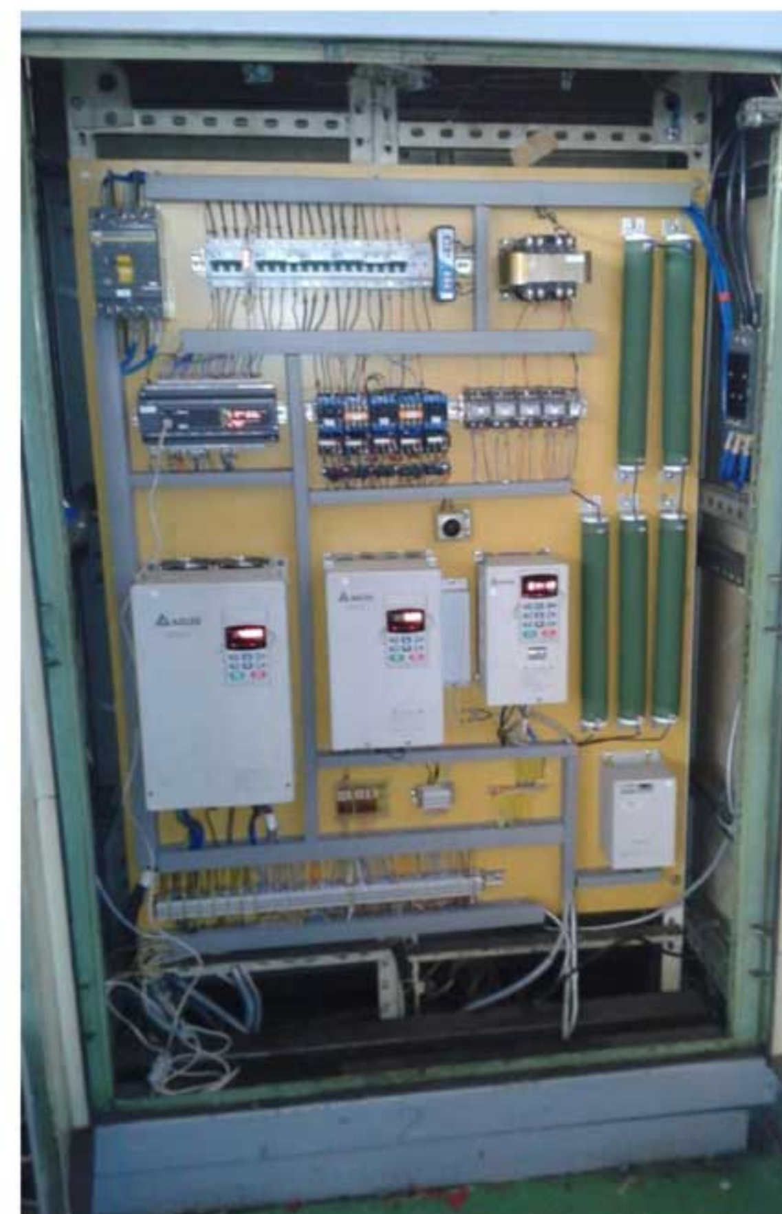
Два варианта электрошкафа модернизированного станка 3А172
