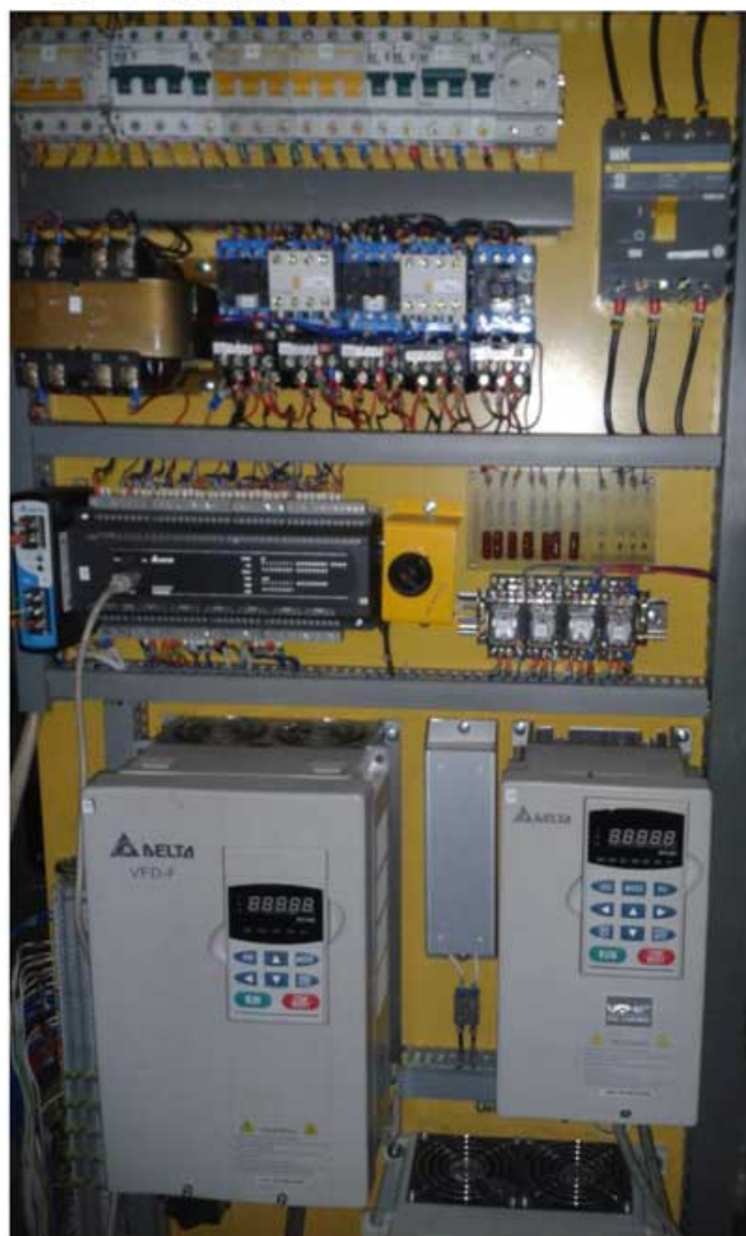
Два варианта электрошкафа модернизированного станка 3А172
