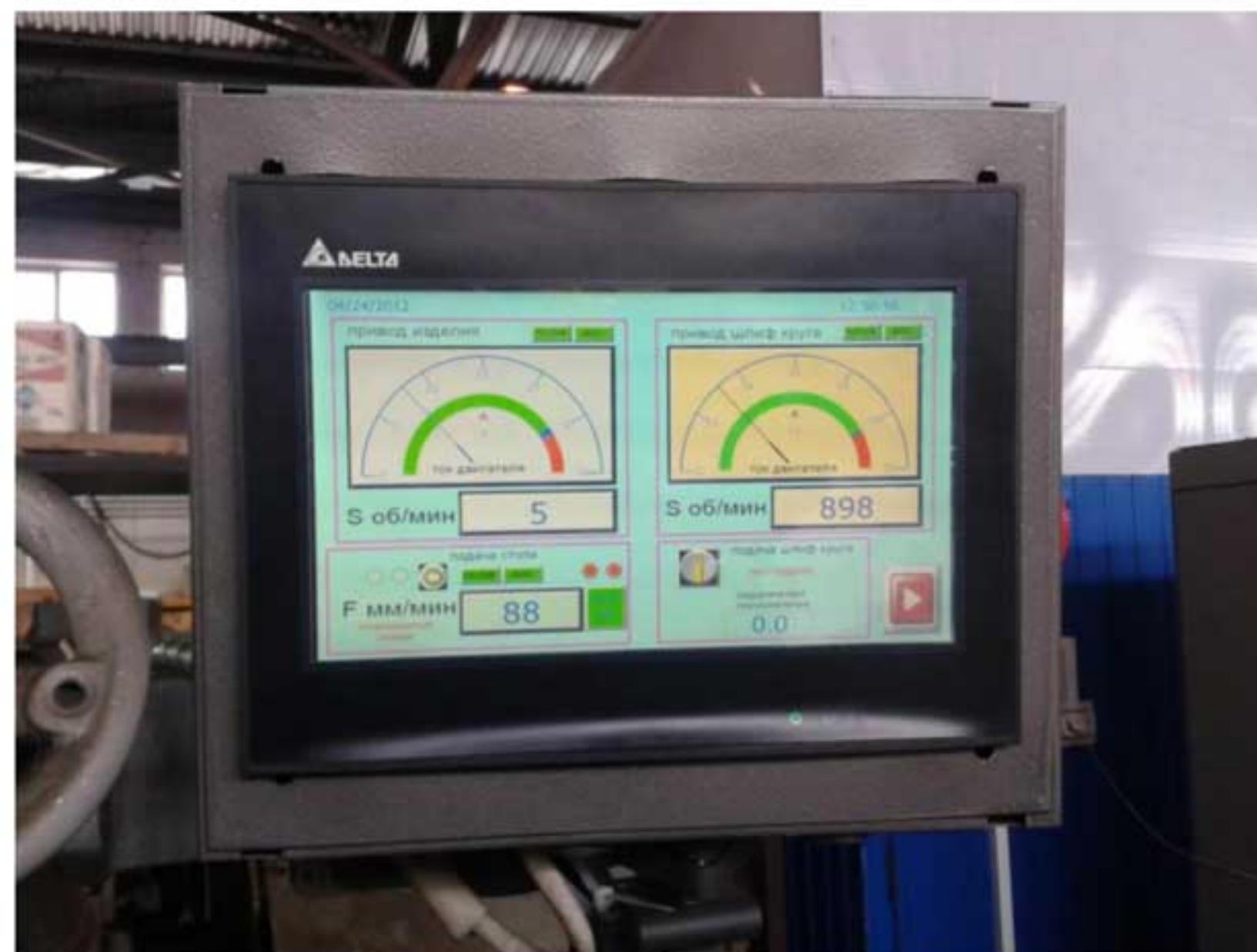
Выносной пульт оператора на базе 10" сенсорной панели мод. DOP-B10S615 для индикации и ввода основных параметров станка (скорость и ток двигателя привода детали и привода шлифкруга, подача стола и подача шлифкруга)
